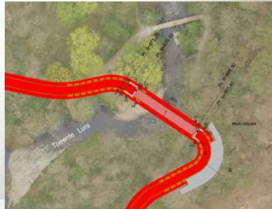
Profilo di progetto del nuovo Ponte degli Alpini avente lunghezza L=20m.
