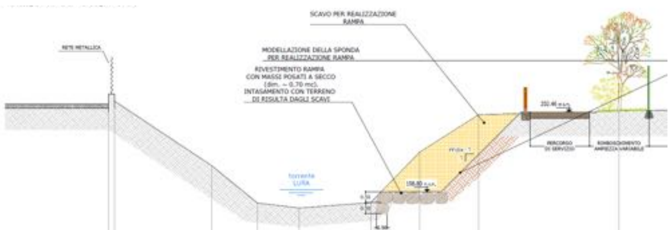
Fig. 6-Sezione trasversale rampa di accesso al Torrente Lura
